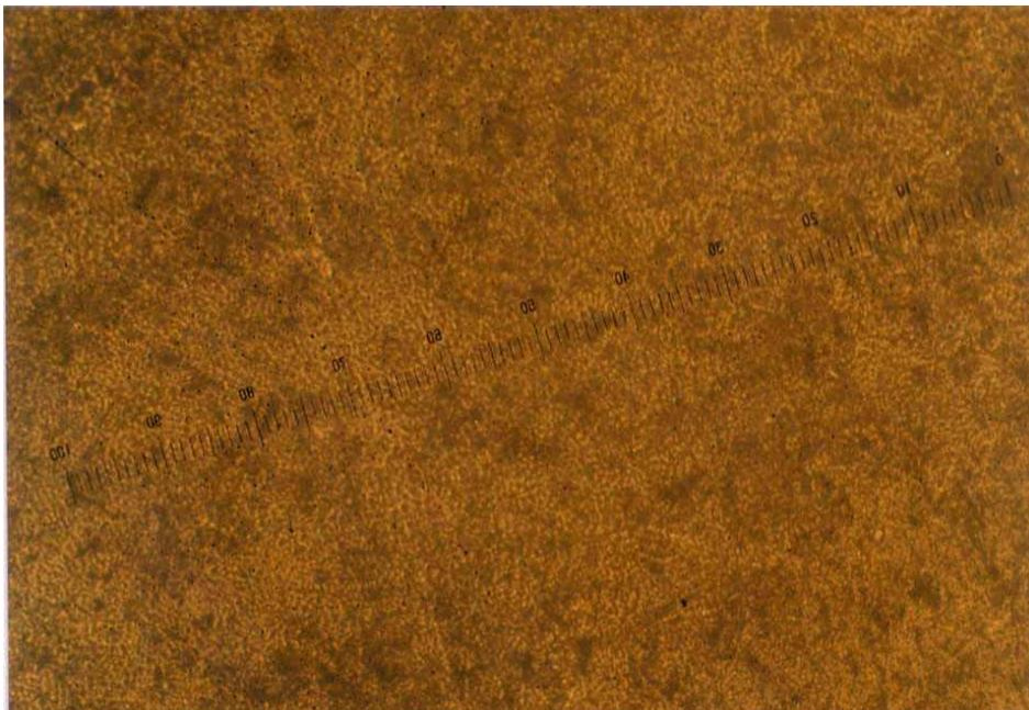
Gambar 4.20. Foto struktur mikro baja AISI 1045 proses *tempering* dengan temperatur 200°C pembesaran 200X
