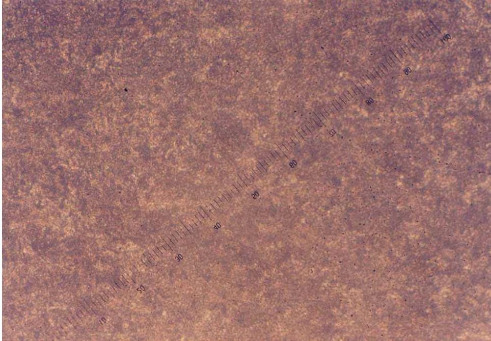
Gambar 4.28. Foto struktur mikro baja AISI 4140 proses *hardening* pembesaran 200X
