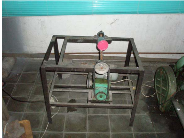
Gambar 3.5. Mesin ballmill yang digunakan dalam pencampuran serbuk Al dengan tepung jagung.
