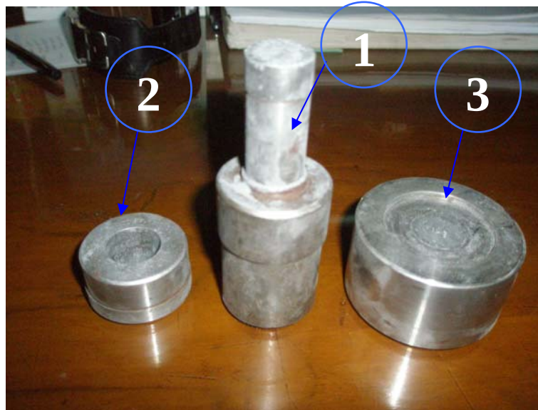
Gambar 3.6. Cetakan kompaksi yang digunakan dalam tugas akhir ini.
