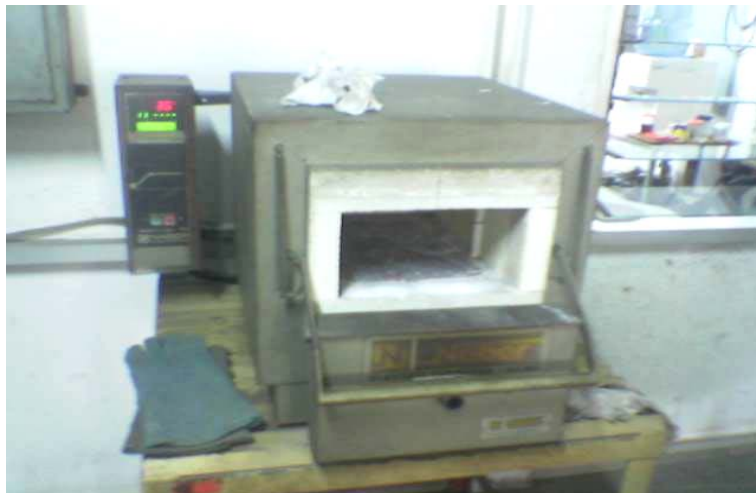
Gambar 3.9. Muffle Furnace di laboratorium Metalurgi jurusan Teknik Mesin UK Petra dengan kapasitas temperatur hingga 1200^{\circ}\text{C} .
