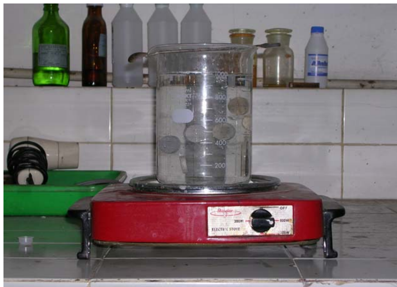
Gambar 3.17. Pemanasan sampel selama 5 jam menggunakan pemanas listrik.
