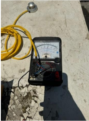
Gambar 4.3 Pengujian Intensitas Matahari menggunakan kombinasi Pyranometer dan Multimeter Analog Krisbow KW06-299 Sumber: Dokumen Pribadi
