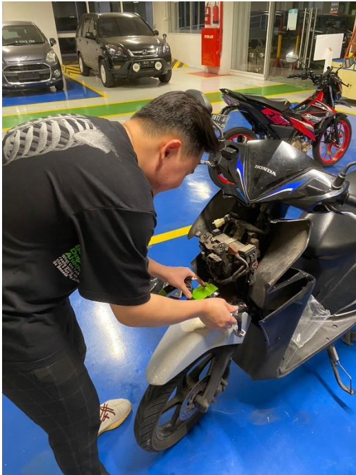
Gambar 3. 3 Pemasangan ECU Juken
