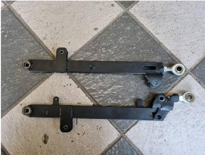
Gambar 2. 11 Swing Arm Suzuki Shogun Modifikasi
