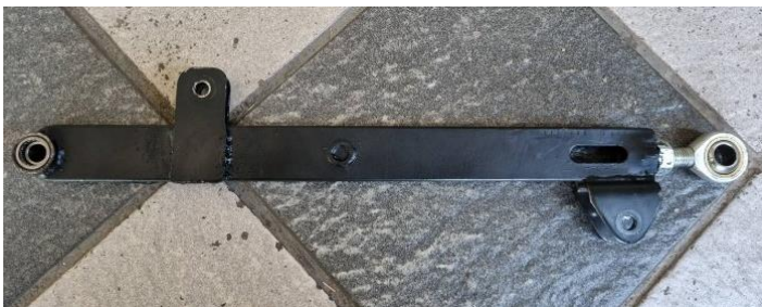
Gambar 2. 12 Swing Arm Suzuki Shogun Modifikasi
