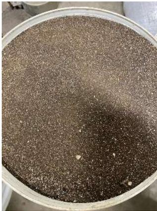
Gambar 2.1 Bentuk Partikel *Bottom ash*
