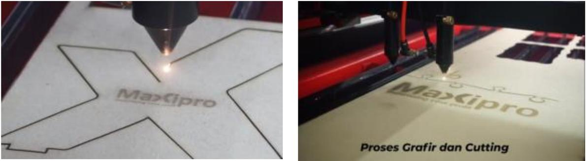
Gambar 2.2 Contoh Penerapan Laser *Cutting*
