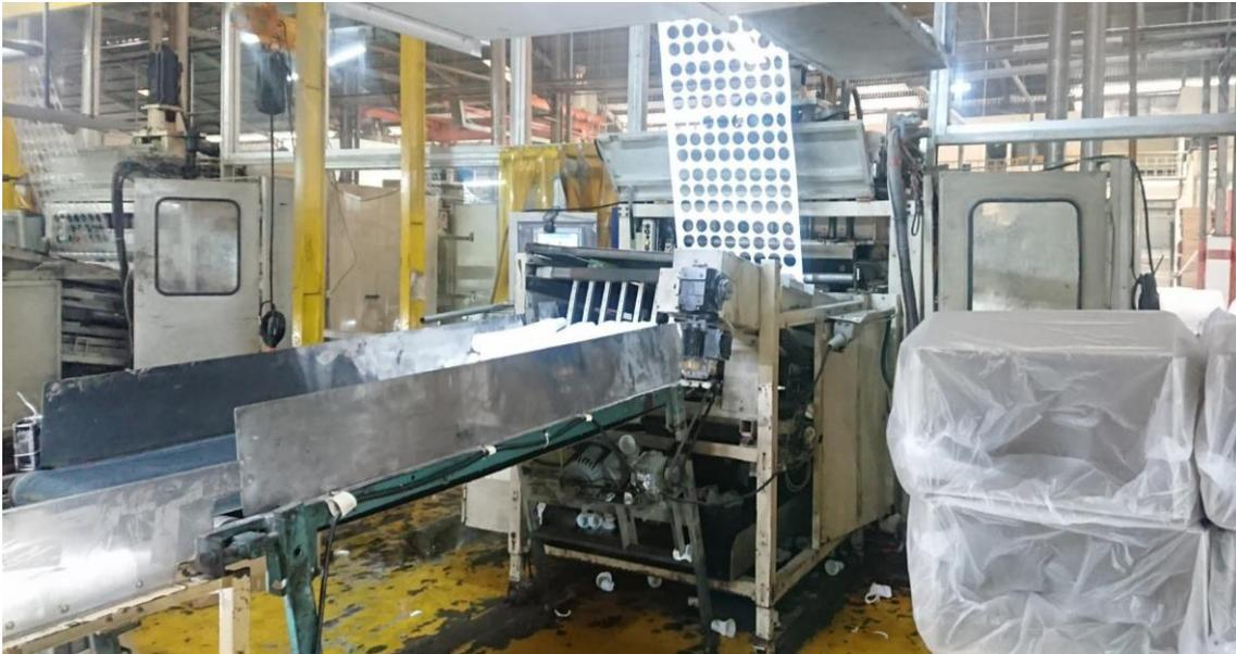
Gambar 4.1. Mesin Illig *Thermoforming* 3 Off-Line di PT X
