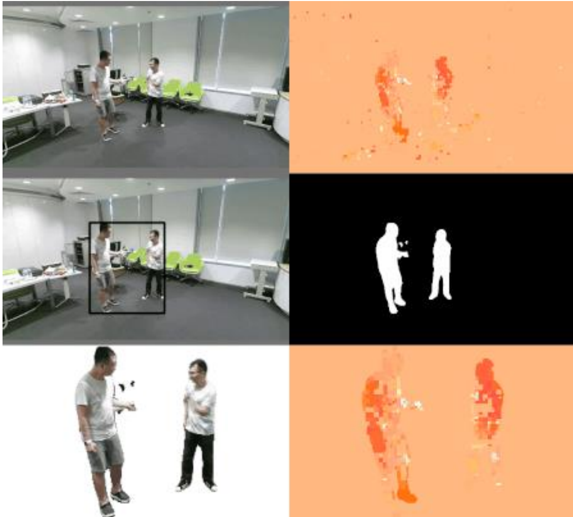
Gambar 3.13 Contoh Proses Masking dan Cropping menggunakan Bounding Box dengan YOLOv7 Mask
