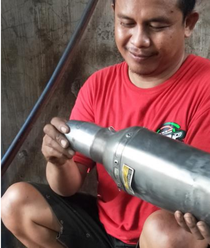
Gambar 3.31 Pengujian Hasil Roll Plat pada Lubang Inlet Silincer Akrapovic
