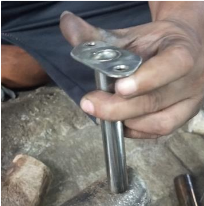
Gambar 3.40 Proses Memastikan Posisi Jalur Drone killer Lurus terhadap Flange
