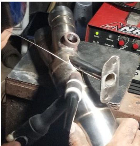
Gambar 3.43 Proses Las pada jalur Drone killer
