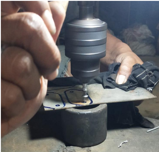
Gambar 3.36 Proses Bor Jalur Baut menggunakan mata bor 6 mm
