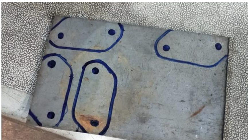
Gambar 3.35 Proses Cetak flange Sesuai Desain
