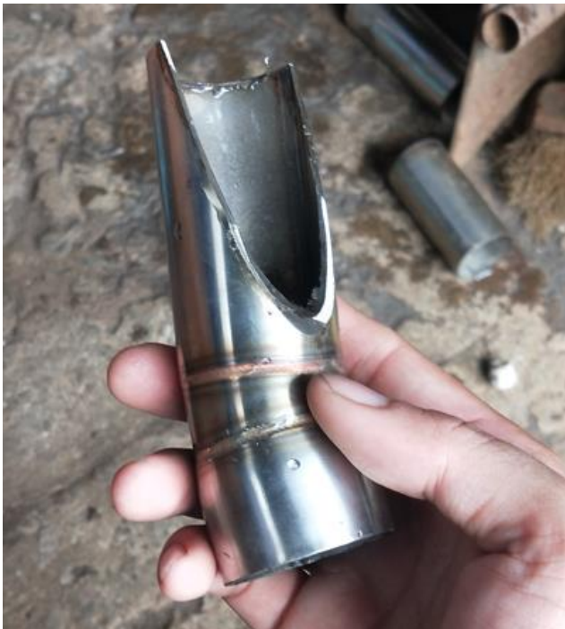
Gambar 3.27 Hasil Pemotongan Pipa Silinder Satu Yang Akan Disatukan Silinder Dua
