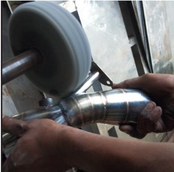
Gambar 3.44 Proses pembersihan atau Poles pipa knalpot
