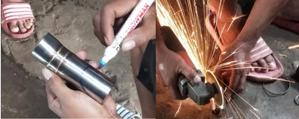
Gambar 3.26 Proses Pemberian Tanda dan Proses Pemotongan
