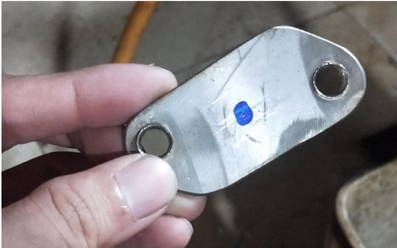
Gambar 3.38 Pemberian Tanda yang Menjadi Acuan Pelubangan
