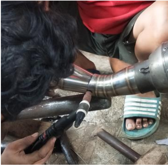
Gambar 3.32 Proses Las Sementara untuk Memastikan Sesuai dengan Desain
