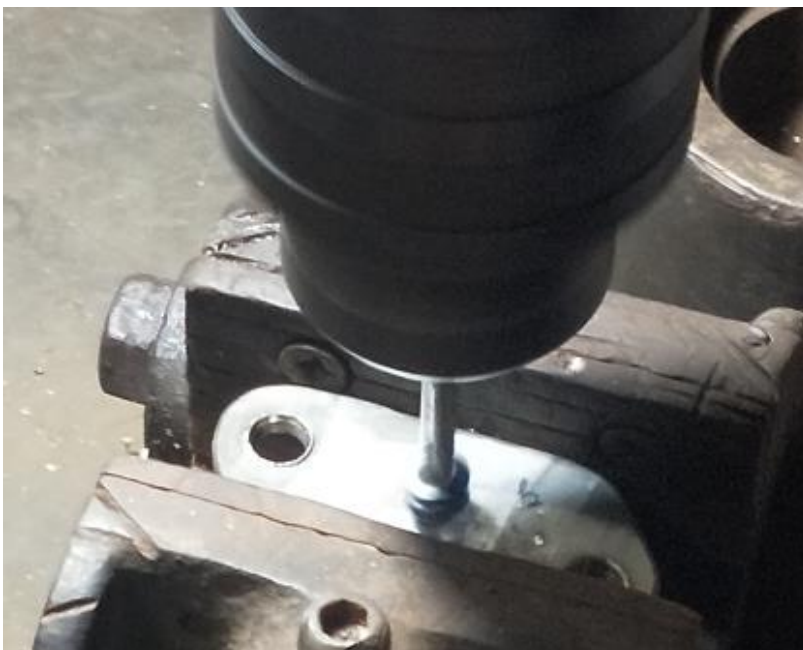
Gambar 3.39 Proses Bor untuk jalur Drone killer dengan Mata Bor 5mm
