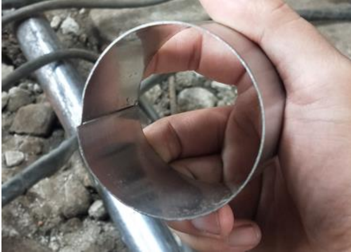
Gambar 3.30 Hasil Plat setelah Proses Roll
