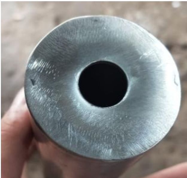
Gambar 3.48 Hasil Pelubangan Salah Satu Sisi Pipa Drone killer
