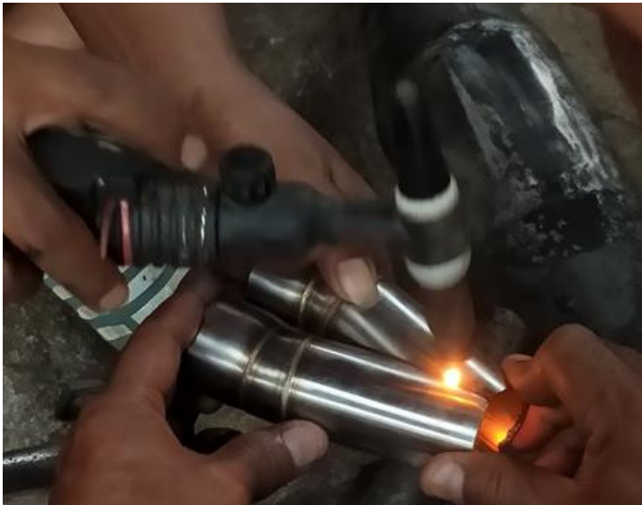
Gambar 3.28 Proses Las Sementara Untuk Memposisikan Pipa pada tempat yang benar
