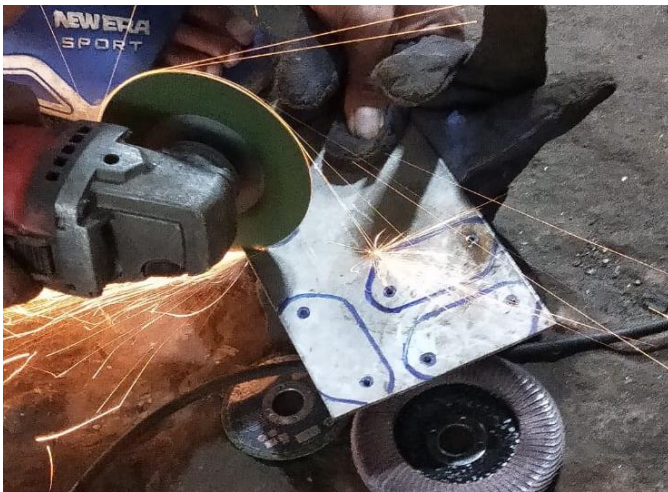
Gambar 3.37 Proses Potong Hasil Cetak Flange
