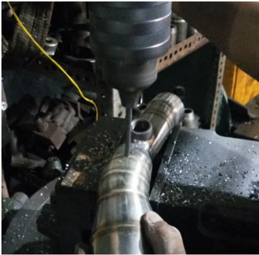
Gambar 3.42 Proses Bor dengan Mata Bor 5 mm
