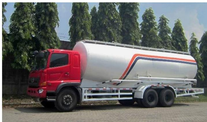
Gambar 2.11 Truk tangki muatan *bulk cement*
