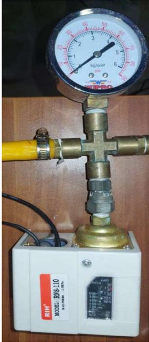
Gambar 3.10 Pemasangan *Pressure Switch* pada *pressure gauge*
