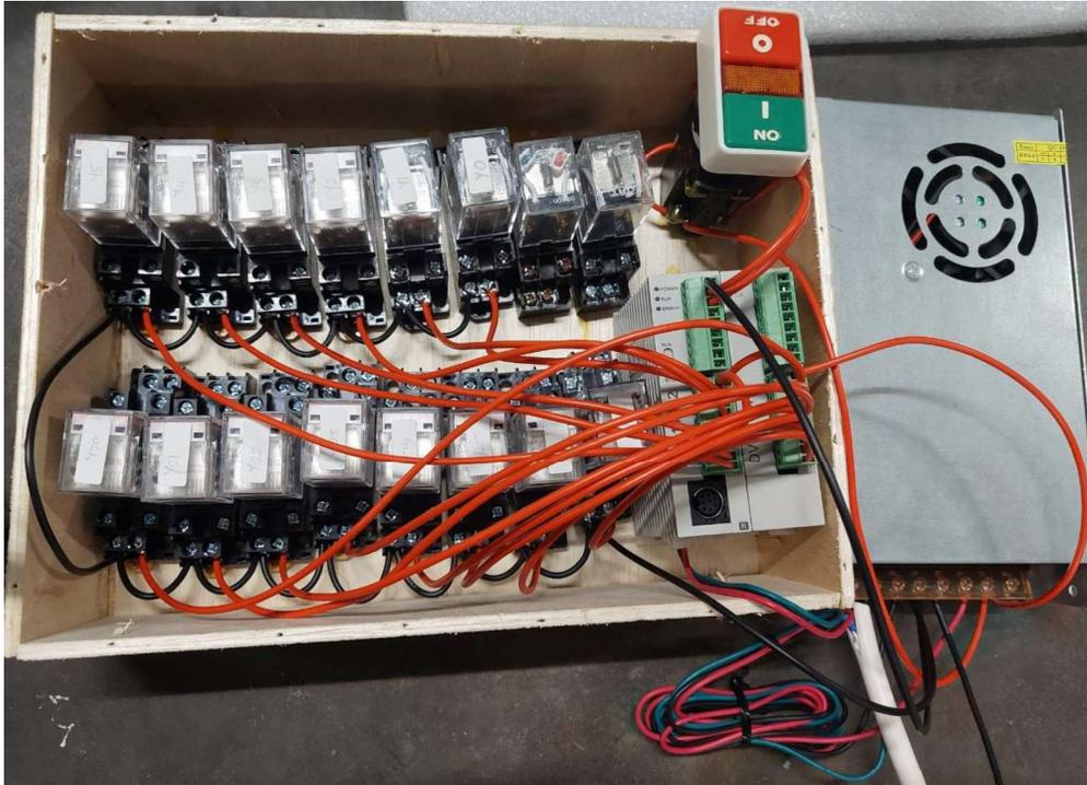
Gambar 3.31 Pemasangan kabel PLC
