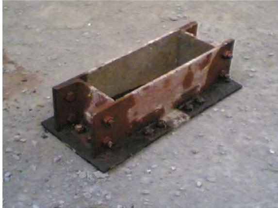
Gambar 2.7. Cetakan sampel uji *shrinkage*
