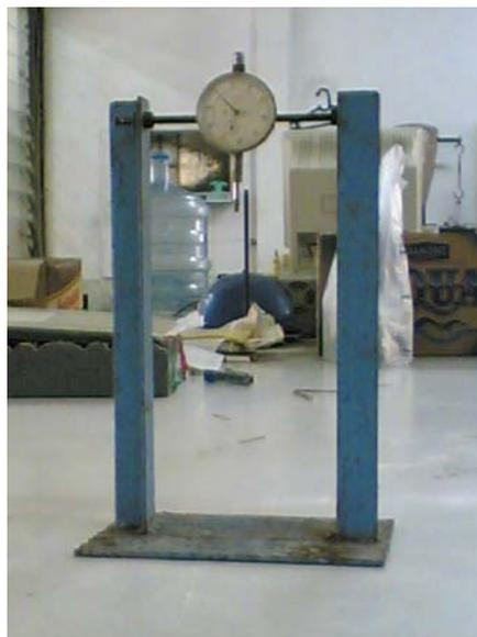
Gambar 2.8. Alat tes *shrinkage* dengan *dial gauge*.
