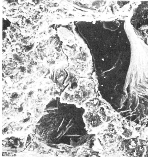
Gambar 2.6. Retak pada beton dilihat dengan alat mikroskop elektron
