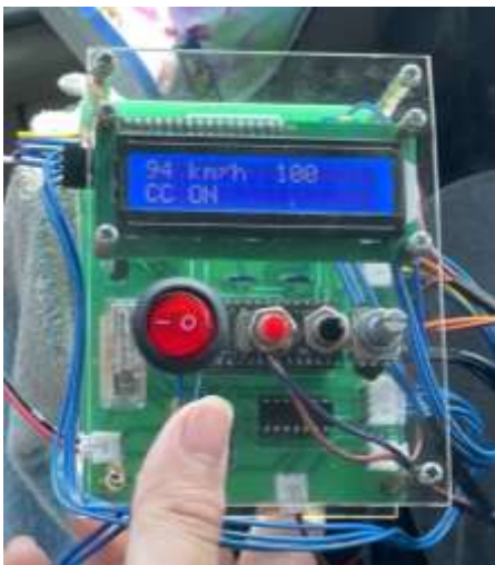
Gambar 4. 9. Tampilan LCD untuk Target Speed 100km/h serta Actual Speed
