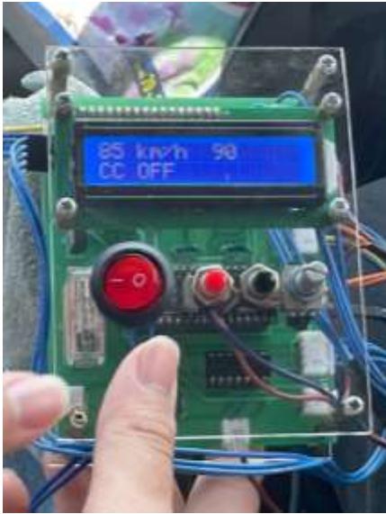
Gambar 4. 8. Tampilan LCD untuk Target Speed 90km/h serta Actual Speed
