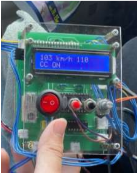
Gambar 4. 10. Tampilan LCD Untuk Target Speed 110km/h serta Actual Speed
