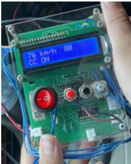
Gambar 4. 7. Tampilan LCD untuk Target Speed 80km/h serta Actual Speed
