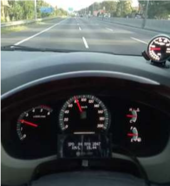
Gambar 4. 4. Pengujian Cruise Control pada Tingkat Kecepatan 80 km/jam
