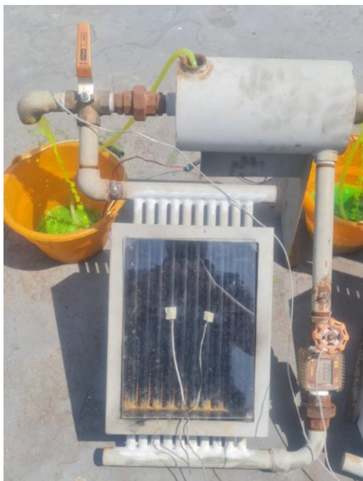
Gambar 4.22 Kolektor Surya Dengan Penutup Flat Lens
