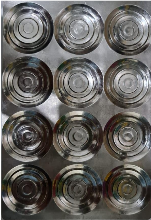
Gambar 4.14 Tampak Atas Matras Setelah Proses EDM
