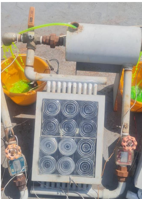
Gambar 4.24 Kolektor Surya Dengan Penutup Lensa Fresnel Rancangan Pertama
