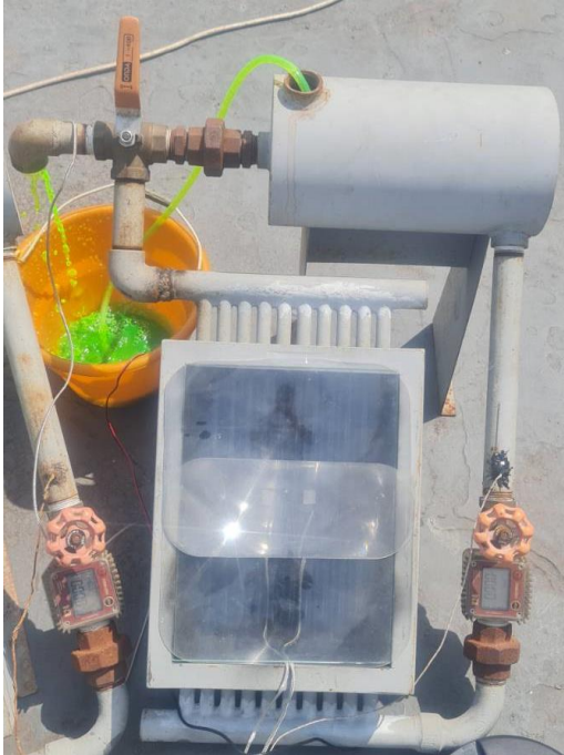
Gambar 4.25 Kolektor Surya Dengan Penutup Lensa Fresnel Komersil
