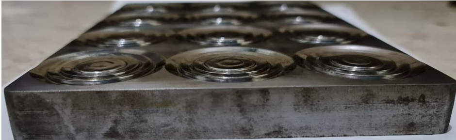
Gambar 4.15 Tampak Samping Matras Setelah Proses EDM
