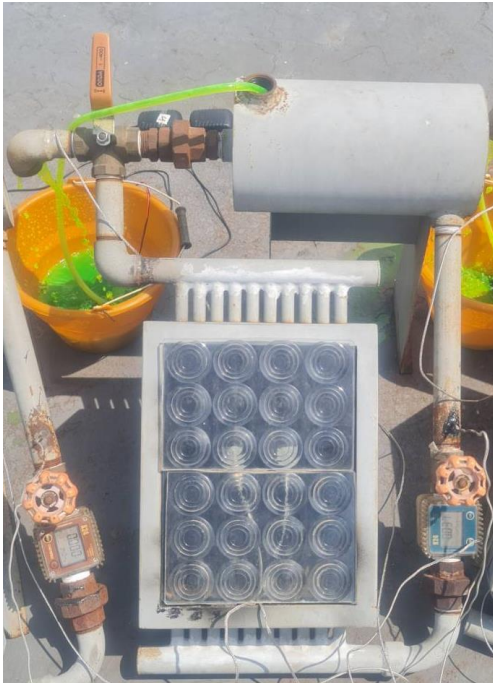
Gambar 4.23 Kolektor Surya Dengan Penutup Lensa Fresnel Rancangan Terbaru
