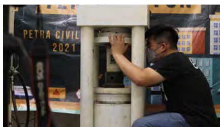
Panitia sedang memasang beton finalis untuk diuji
