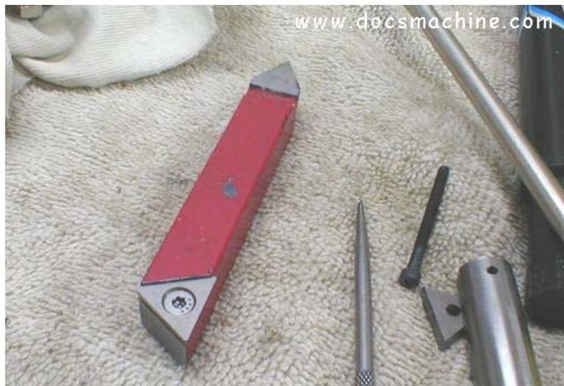
Gambar 2.4. *Tool* pada mesin bubut. <http://www.docsmachine.com>
