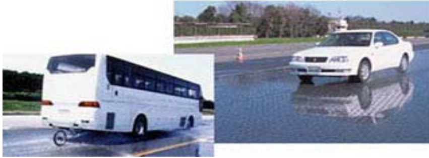
Gambar 2.5. a) Pengujian Pengereman pada Kecepatan Tinggi b) Pengujian ABS
