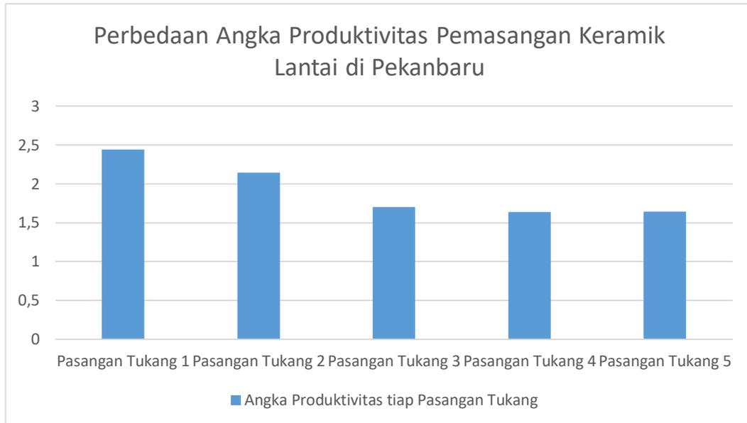
Gambar 4.6 Grafik Perbedaan Angka Produktivitas Pemasangan Keramik Lantai antara Pasangan Tukang di Pekanbaru (no 9)
