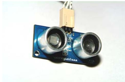
Gambar 3.10. Sensor Jarak
