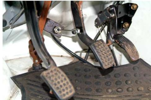
Gambar 3.14. Mekanisme Kawat baja
