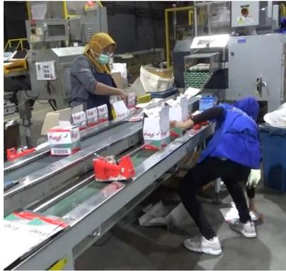
Gambar 4.6. Operator Mengambil *Folding Box* yang Jatuh
