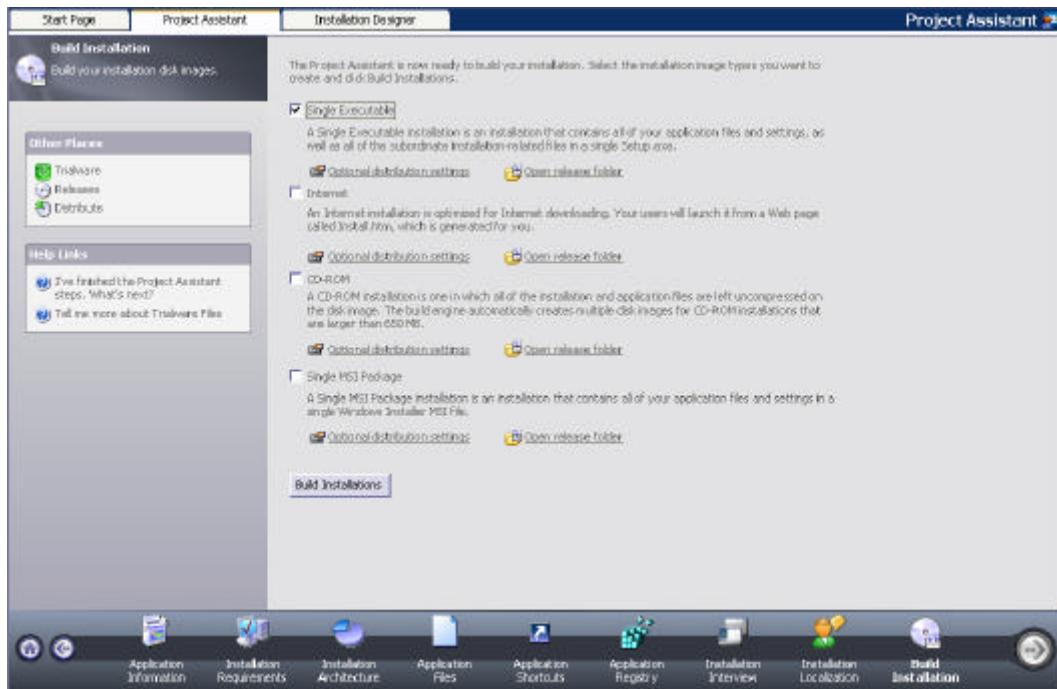
Kemudian setelah sampai pada halaman ini, untuk membuat *installer* dari program yang sudah dimasukkan pada halaman-halaman sebelumnya, beri tanda tick pada *Single Executable* untuk membuat sebuah file *installer*. Kemudian tekan tombol **Build Installations** untuk mulai membuat file *installer*. File *installer* yang sudah jadi nantinya akan diletakkan sesuai dengan lokasi yang telah ditentukan pada halaman *create new project*.
