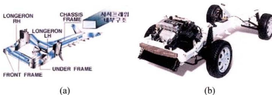
Gambar 2.4 (a) *Backbone Chassis* (b) Model mobil balap mini
