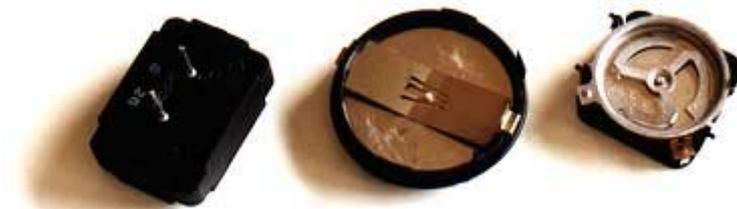
Gambar 2.23. Bagian dalam *transducer*
