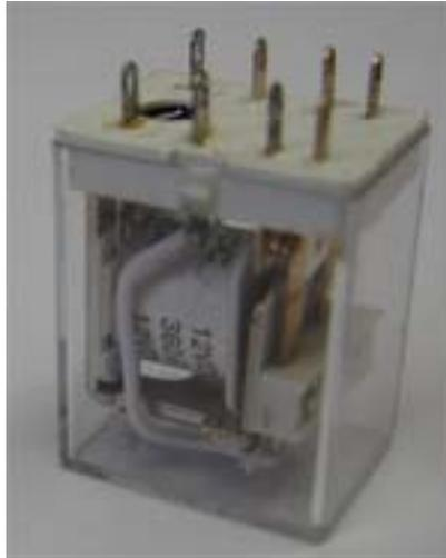
Gambar 2.18. Bentuk fisik relay 4 kontak
