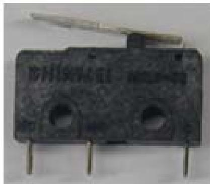
Gambar 2.17. Bentuk fisik limit switch
