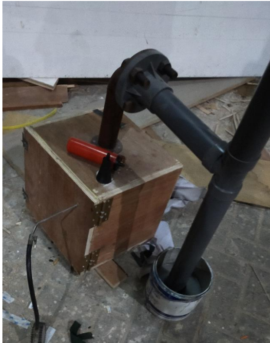
Gambar 4.16 Model incinerator setelah mengalami revisi kedua.
