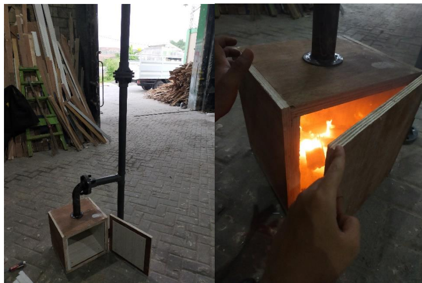
Gambar 4.14 Model incinerator dengan skala 1:4.
