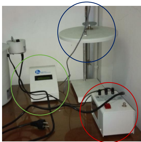
Gambar 3.13 Thermostat, pengaduk dan ignition button
