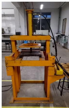
Gambar 3.15 Mesin press dengan aktuator hidrolis
