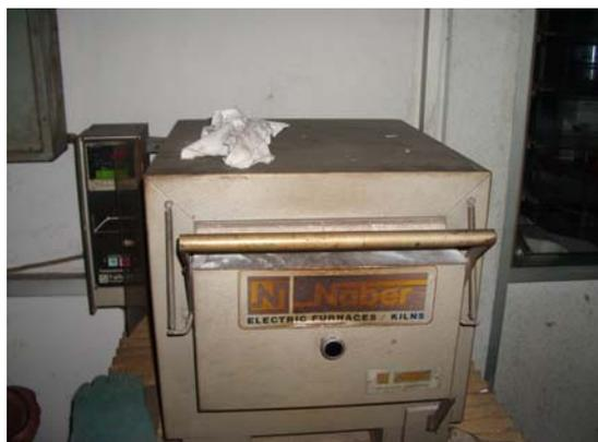
Gambar 3.14. *Muffle furnace* yang digunakan untuk pemanasan pra-*sinter* sampel
