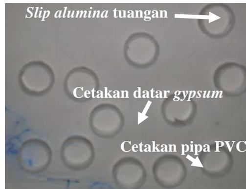
Gambar 3.11. Slip yang telah dituangkan pada cetakan
