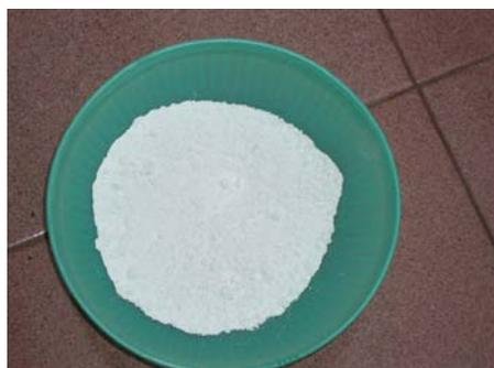
Gambar 3.6 Serbuk *gypsum* untuk bahan cetakan *slip casting*
