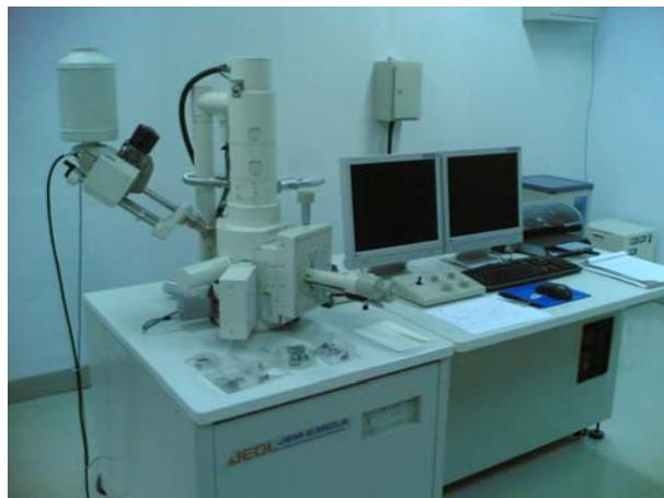
Gambar 3.18. Pengujian SEM di P3GL Bandung
