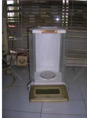
Gambar 3.9. Timbangan digital Mettler Toledo di laboratorium Metalurgi Universitas Kristen Petra
