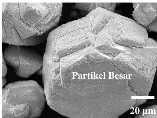
Gamabr 3.2. Foto SEM alumina dengan bentuk partikel *polygonal*
