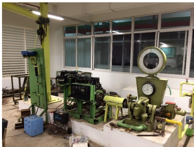
Gambar 3.30. Satu Set Engine Diesel (ISUZU) dan Water Brake Dynamometer
