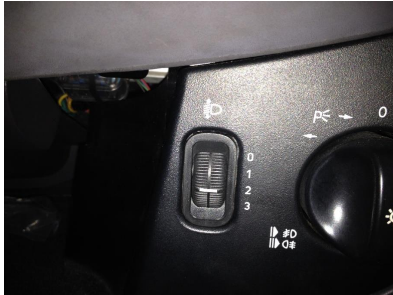
Gambar 2.10. Tombol pengatur ketinggian lampu pada A140
