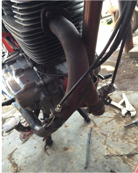
Gambar 3.6. Pemasangan Knalpot Dualsound Dari Exhaust Port
