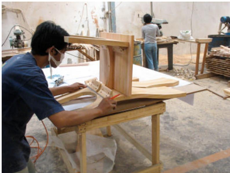
10. Pemasangan konstruksi kursi (joint segitiga dan palang tengah) dengan menggunakan bor.
