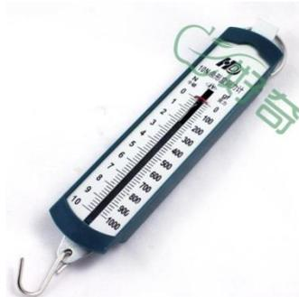
*Gambar 3.6. Dinamometer Pegas
