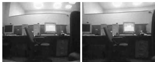
Gambar 2.5. Perbedaan Image Sebelum (kiri) dan Sesudah (kanan) Proses Undistorsi (Sumber: Open source computer vision library: Reference manual)
