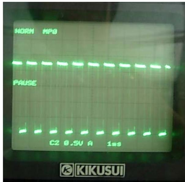
Gambar 4.5. Hasil Respon pada *Oscilloscope* untuk Sinyal *Input* yang Besarnya di atas 0.021V, 1KHz dan *Gain*=400.
