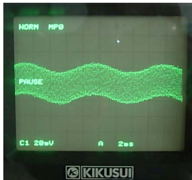
Gambar 4.25. Hasil Respon Signal 1KHz,0.5V dan 5KHz, 0.5V pada *Oscilloscope*
