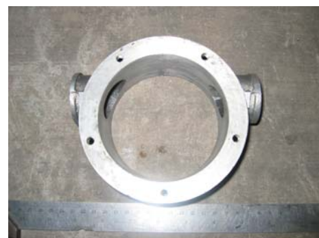
Gambar 12. Produk Cor Belum Finishing
