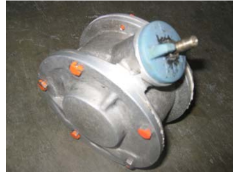
Gambar 2. Rumah Pompa Tampak Kanan
