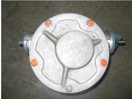
Gambar 1. Perakitan Rumah Pompa
