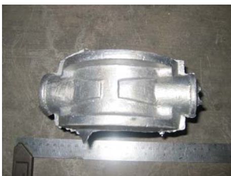
Gambar 11. Produk Cor Belum Finishing
