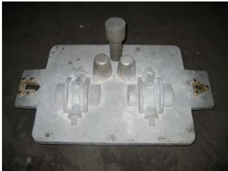
Gambar 1. Match Plate Bagian Atas
