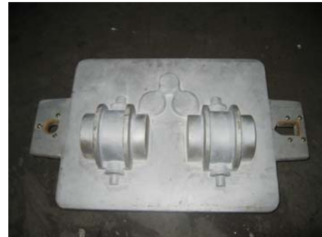
Gambar 2. Match Plate Bagian Bawah
