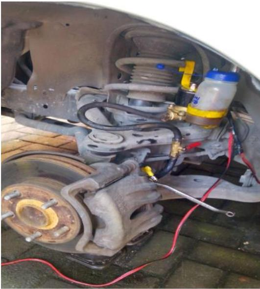
Gambar 2.16 Proses *Bleeding* Minyak Rem
