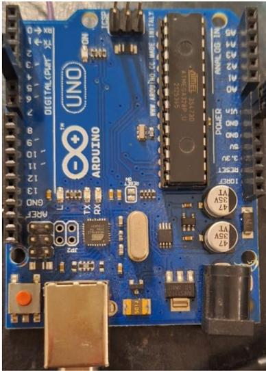
Gambar 2.8. *Microcontroller* Arduino UNO
