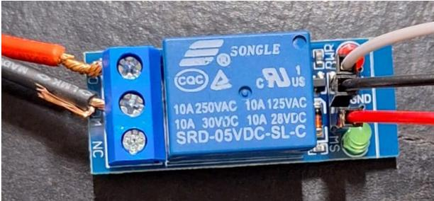
Gambar 2.9. Relay Arduino.
