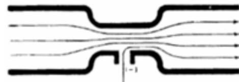
Gambar. 15 Tabung Venturi Yang Mengambarkan Efek Bernoulli.
