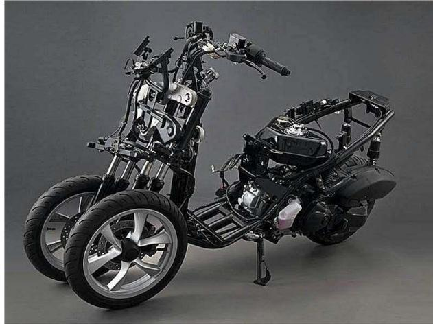
Gambar 2.17 Teknologi Leaning *Multi Wheel* pada Yamaha Tricity
