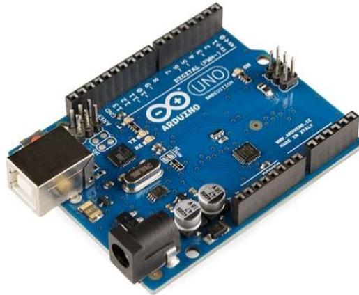
Gambar 2. 2 Mikrokontroler Arduino UNO
