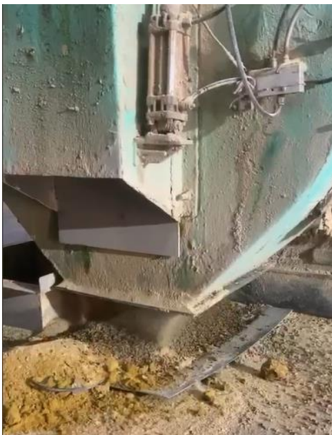
Gambar 4. 9 Penutupan Jalur Produksi dengan Plat Saat Awal Jalan
