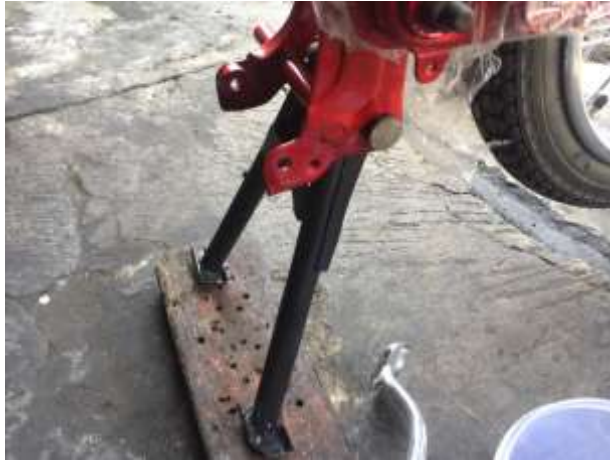
Gambar 4.46 Hasil pemasangan stand .
