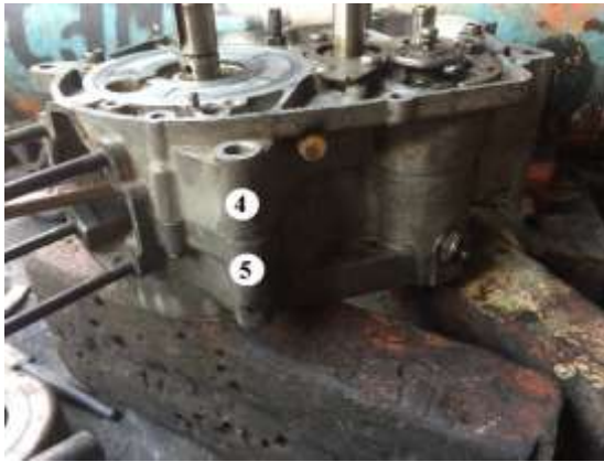
Gambar 4.37 Hasil pemasangan left crank case dan right crank case .
