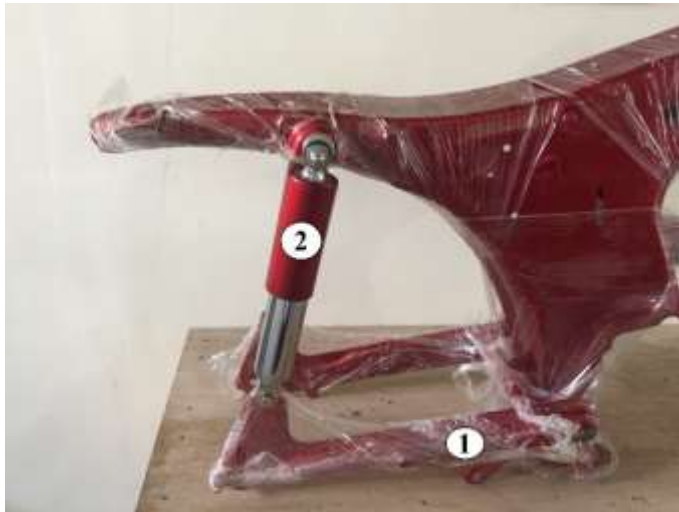
Gambar 4.23 Hasil pemasangan rear cushion dan rear arm .
