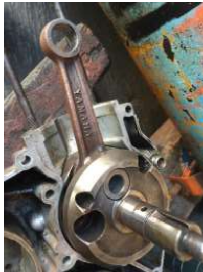
Gambar 4.36 Hasil pemasangan Crankshaft dan connecting rod .
