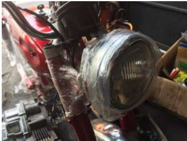
Gambar 4.30 Hasil Pemasangan Lampu depan.
