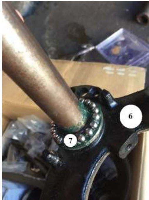
Gambar 4.26 Hasil pemasangan under bracket com dan ball race . 8. Front fork dipasangkan pada under bracket comp dan pada frame ..
