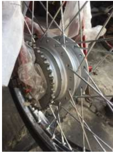
Gambar 4.25 Hasil pemasangan sprocket wheel gear .
