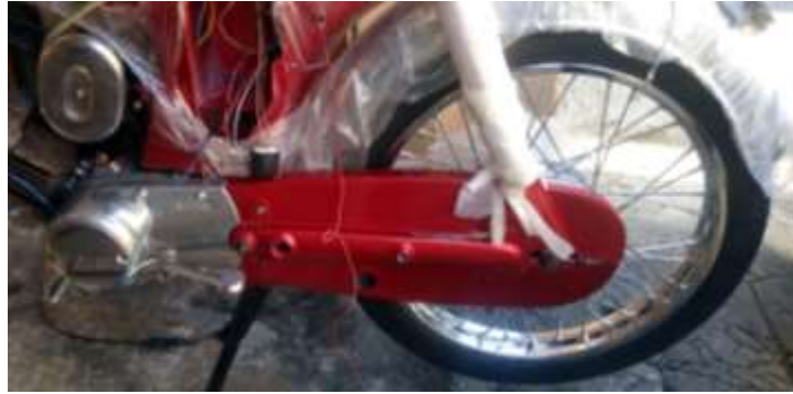
Gambar 4.48 Hasil pemasangan chain case .
