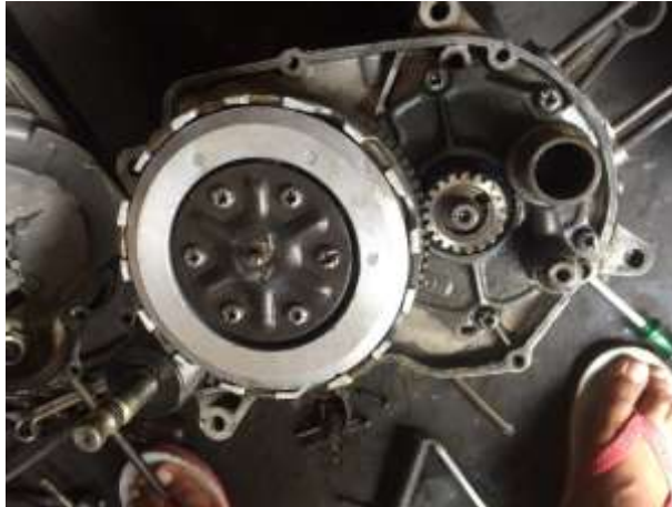
Gambar 4.39 Hasil Pemasangan clutch ass'y .
