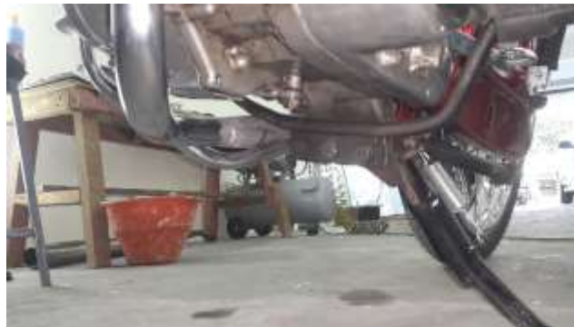
Gambar 4.47 Hasil pemasangan footrest .
