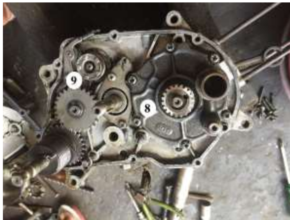
Gambar 4.38 Hasil pemasangan shifter A dan cover valve .
