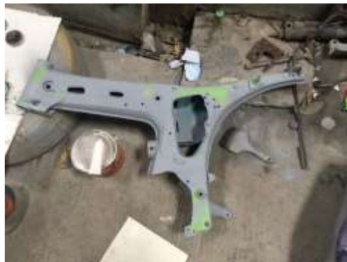
Gambar 4.2 Hasil Pendempulan dan primer epoxy .
