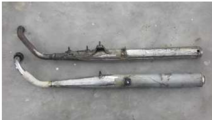
Gambar 4.19 Hasil pembuatan Knalpot original (atas) dan buatan (bawah).
