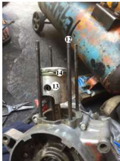
Gambar 4.40 Hasil pemasangan piston , ring piston dan cylinder holding bolt .
