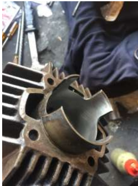
Gambar 4.13 Hasil Cylinder setelah proses bubut.
