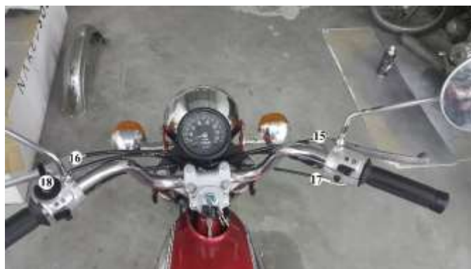
Gambar 4.29 Hasil pemasangan kabel rem depan, kabel kopling, kabel starter dan kabel throttle .
