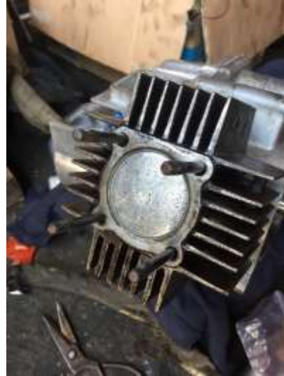
Gambar 4.41 Hasil pemasangan cylinder .
