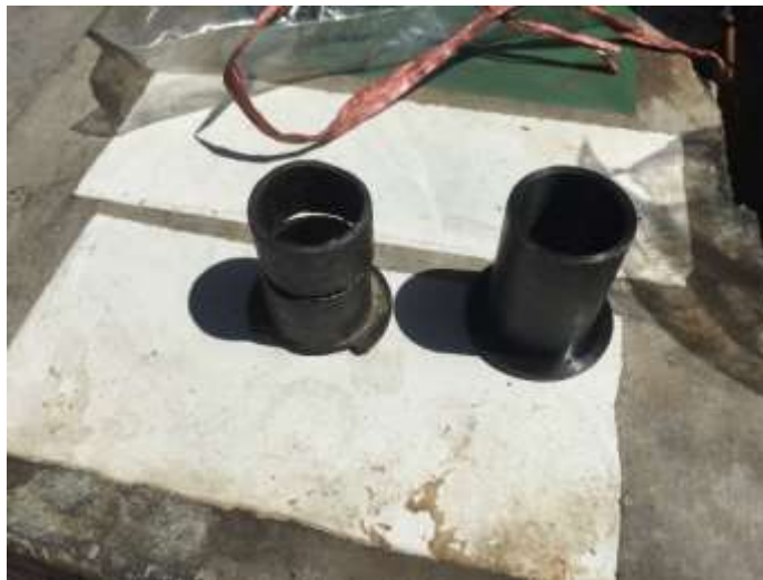
Gambar 4.9 Spring under seat lama (kiri) dan baru (kanan).
