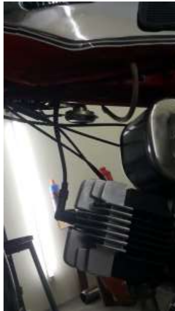
Gambar 4.20 Hasil pemasangan ignition coil dan cap spark plug .
