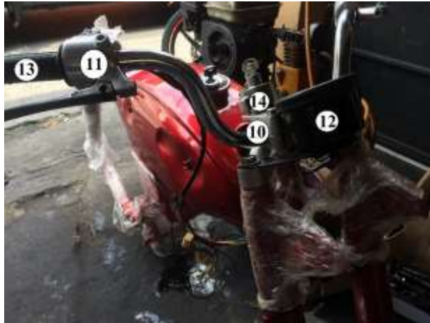
Gambar 4.28 Hasil pemasangan handle , lever handle , speedometer , handle grip dan main switch ass'y .
