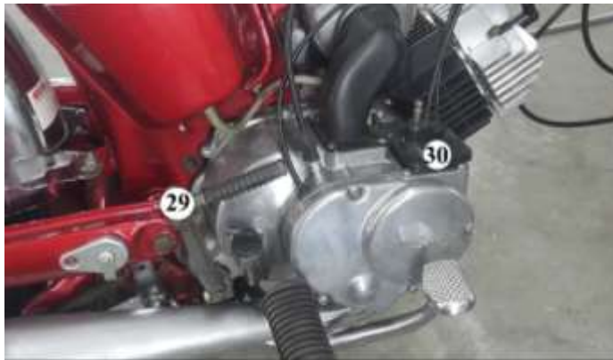
Gambar 4.45 Hasil pemasangan kick crank dan carburetor .
