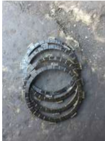
Gambar 4.14. Kampas Kopling yang sudah pada batas keausan.
