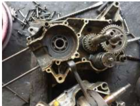
Gambar 4.15 Transmisi Yamaha L2G yang telah dibongkar.
