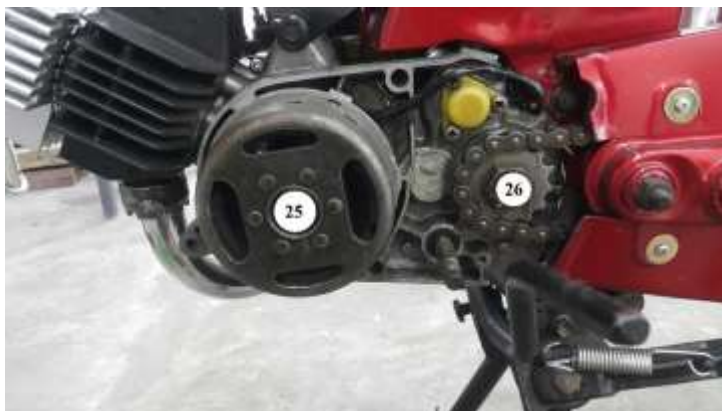
Gambar 4.44 Hasil pemasangan flywheel magneto ass'y dan drive sprocket .
