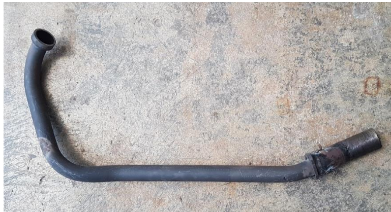
Gambar 3. 11 Pipa Primer Knalpot Standar yang Digunakan untuk Knalpot Modifikasi ( Dipotong pada Bagian Pipa Sekunder)
