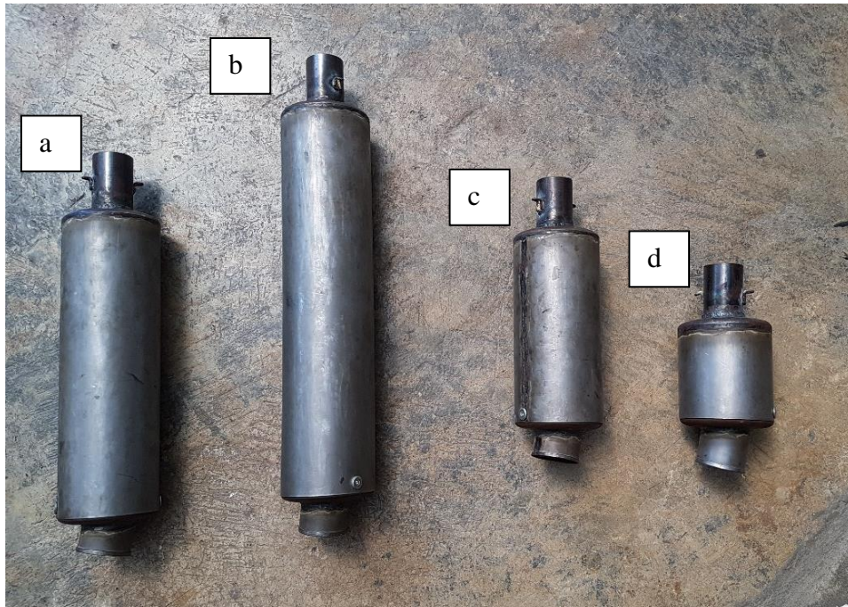
Gambar 3. 15 Panjang Silencer : a. 30 cm , b. 40 cm , c. 20 cm , d. 10 cm
