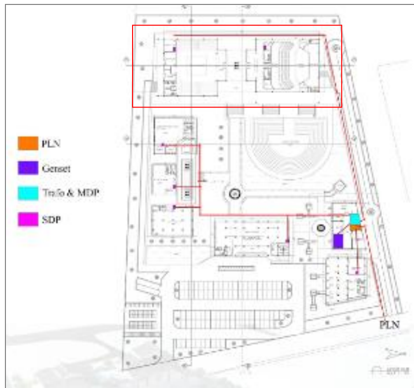
Gambar 3.24. Sistem utilitas listrik
