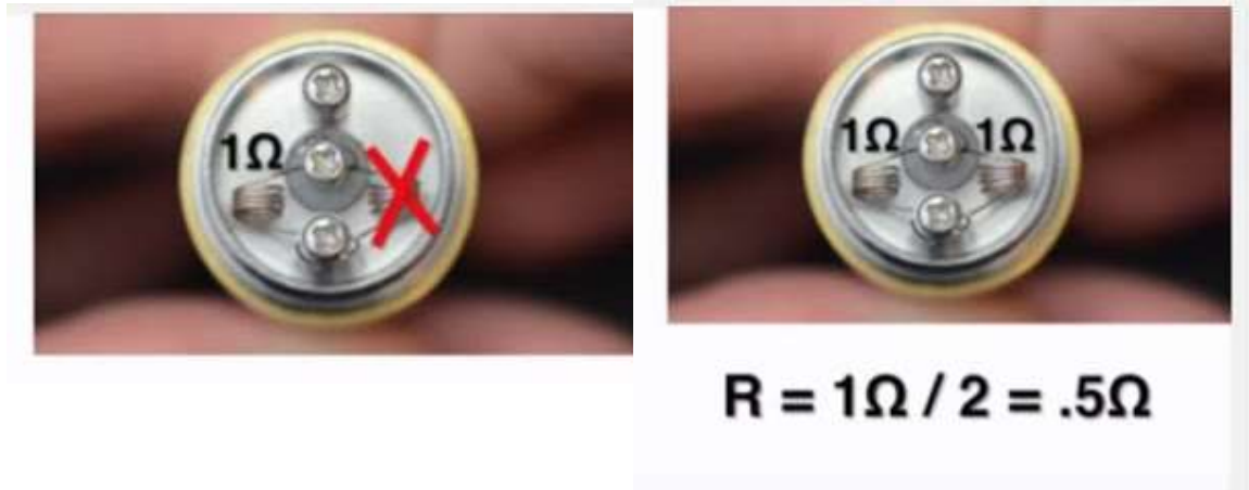
Gambar 2.6 penjelasan coil yang benar
