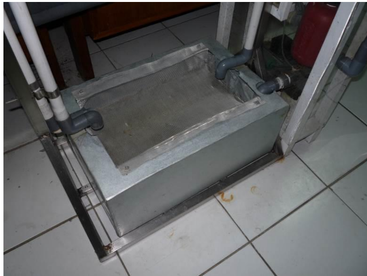
Gambar 3.16. Penempatan bak penampung air pada sisi bawah kerangka maket
