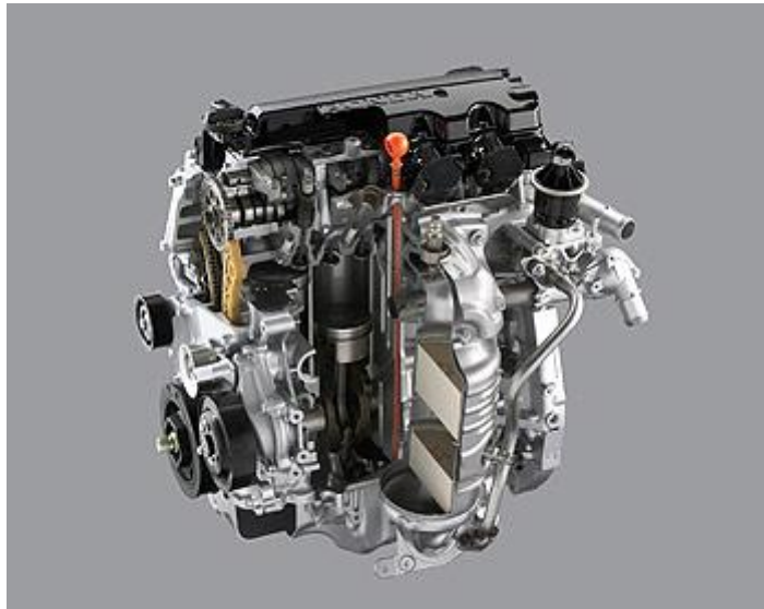
Gambar 2.4. Mesin bensin injeksi
