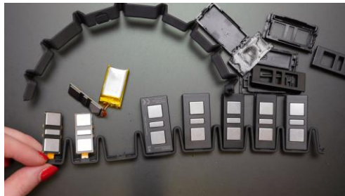
Gambar 2.8 Sensor electromyograph pada Myo Armband (Myo, 2016)
