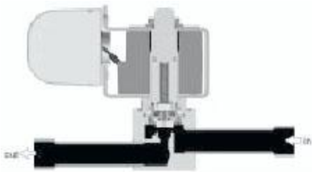
Gambar 2.7. Kondisi katup terbuka pada Pilot Operated .
