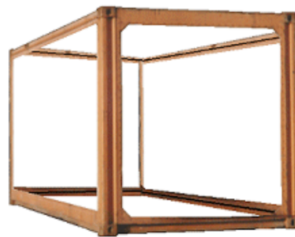
Gambar 2.6. Rangka dasar kontainer
